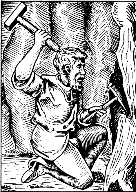
Abb. 9. Gewinnungsarbeit mit Schlägel und Eisen, umgezeichnet nach einer Darstellung nach AGRICOLA 1556. Schlägel und Eisen gekreuzt sind das bekannte Bergmannssymbol
